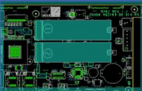
2 slots M.2 NVMe PCIe Gen 3 x1 SSD
