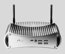
01- Botão liga/desliga 07- USB 3.0 02- LEDs indicadores 08- HDMI 2.0 03- Type C 09- HDMI 2.0 10-DP (displayport) 04- Fone de ouvido 05-USB 3.0 11-1x GbE 06- USB 3.0 12-1x GbF 13- Fonte DC
